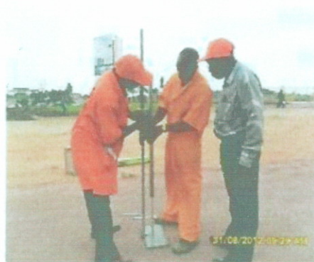
Essai à la Sonde de Battage légère au 30 ème jour
